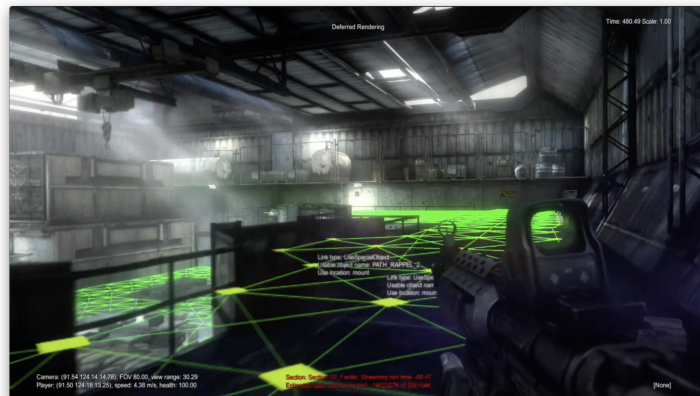
FIGURE 4.3 – Navigation meshes dans le jeu vidéo Killzone . Ce graphe (en vert clair) normalement invisible aux joueurs est proche d'une grille avec ses diagonales.
